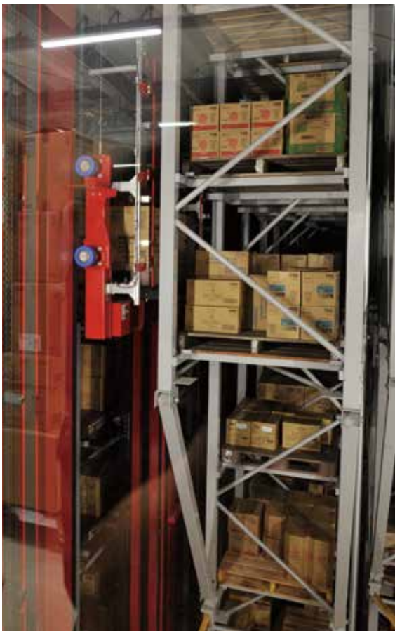
3848棚のパレット収納倉庫。レーン間移動を自動化し、夜間の無人補充出荷が可能になった
