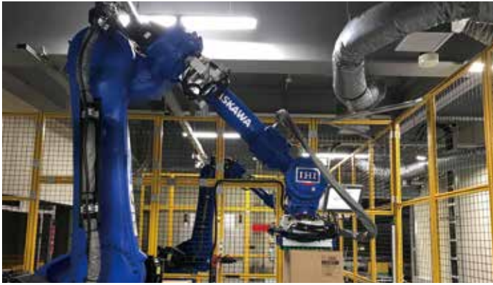
初導入したAIデパレタイズロボット。重作業を軽減し、様々な荷姿のケースを認識し自動出庫する
