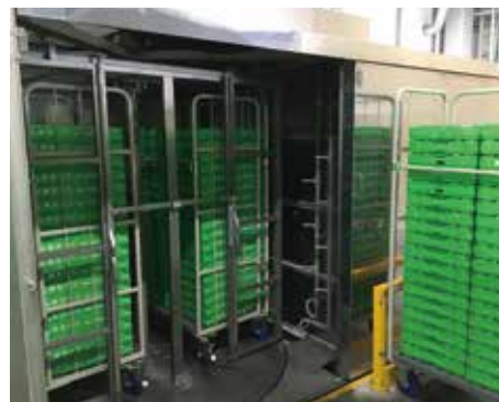
桜島の降灰によって汚れやすいオリコンを自動洗浄する装置。脱水後に組み立てて乾燥させ、そのままコンベアに投入。ピッキング時に組み立てる手間を省く
