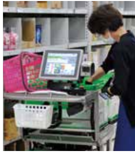
重量検品カート・アイマス(AIMAS)が活躍する3階のバラピッキングエリア。スキャナで商品違い、重量カートで数量違いを検知し、ほぼ100%の納品精度を実現
