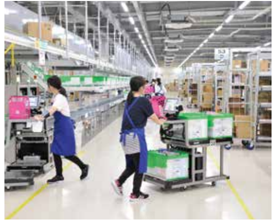
重量検品カート・アイマス(AIMAS)が活躍する3階のバラピッキングエリア。スキャナで商品違い、重量カートで数量違いを検知し、ほぼ100%の納品精度を実現
